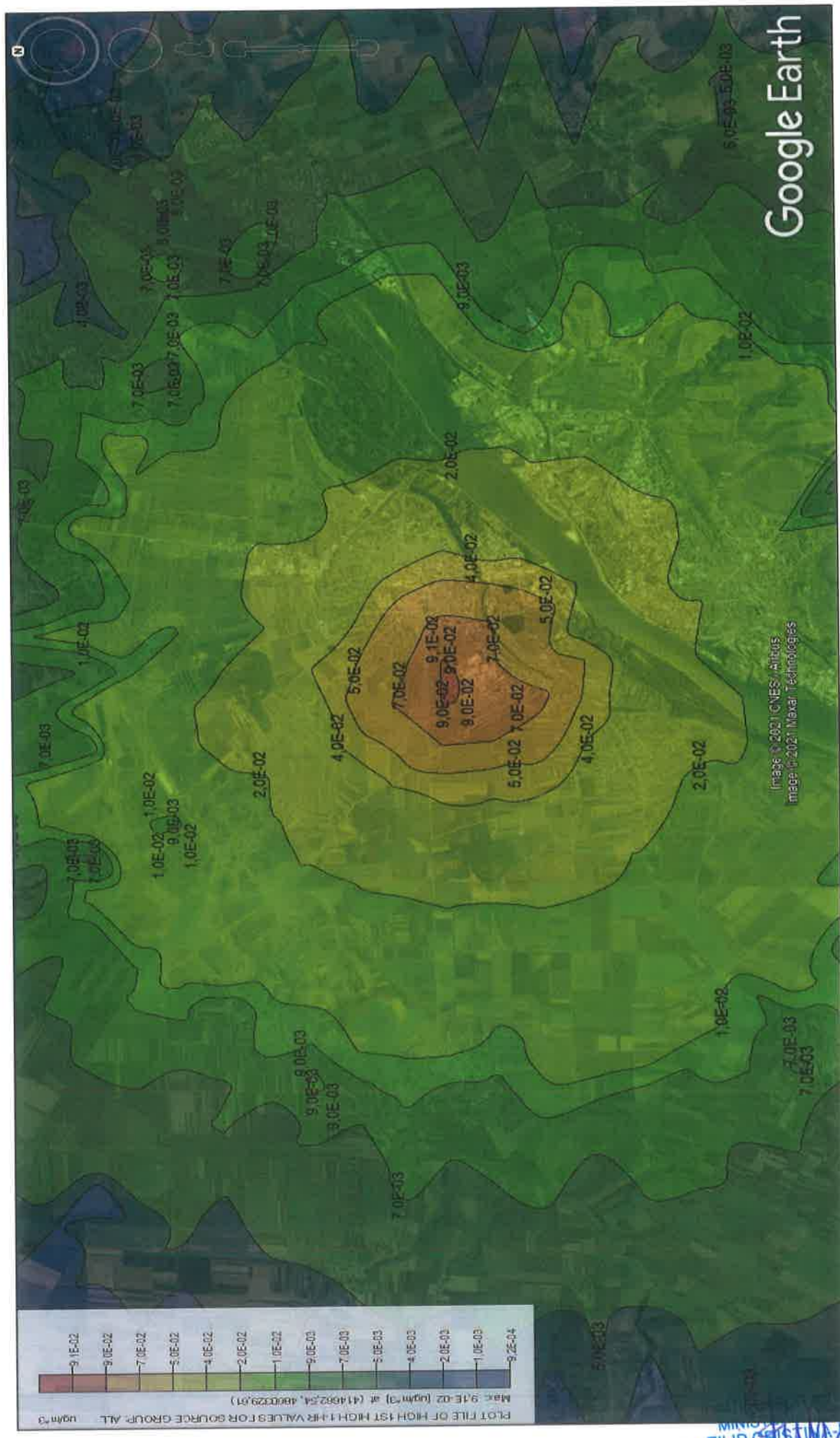
Чертеж 73 - Моделирани дисперсията на SO2 – период на осредняване 30 минути (детайл)
