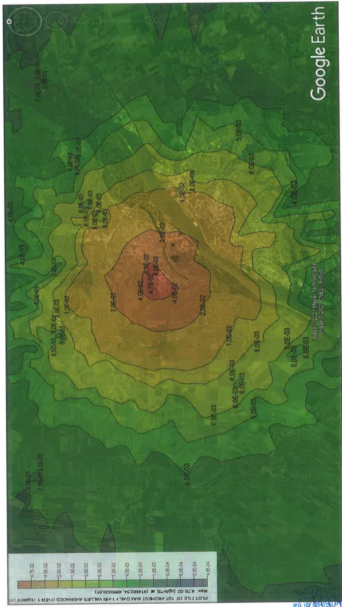
Чертеж 59 -Моделиране дисперсията на SO2 – период на осредняване 1 ч (детайл)
