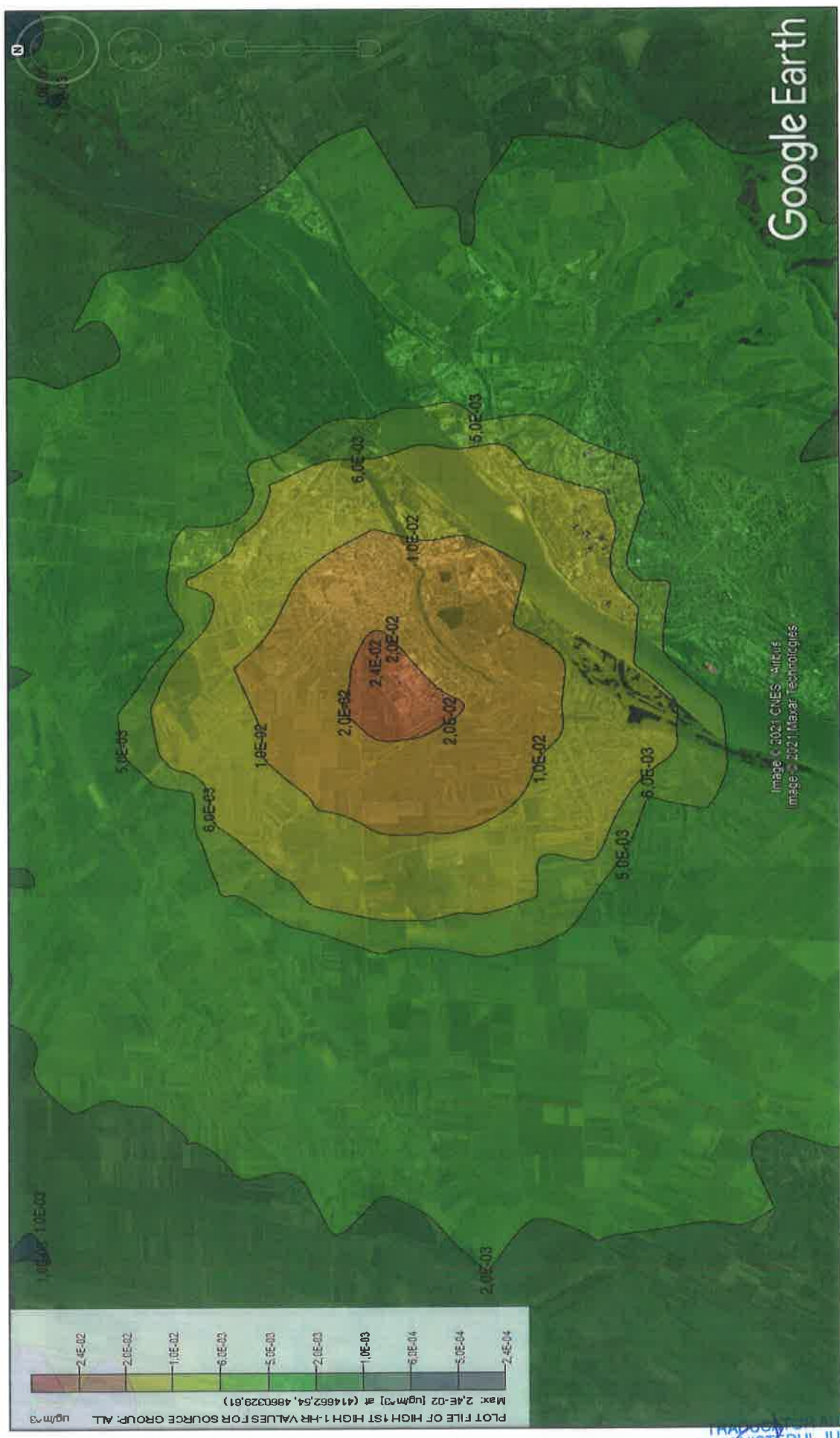
Чертеж 53 - Моделиране дисперсията на TSP – период на осредняване 1 ч (детайл)
